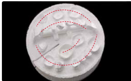
Qu'elles possèdent ou non un support de frittage, les armatures peuvent être frittées simultanément. Attention au choix du programme. Les armatures ne doivent pas se toucher. Ne placer aucune armature sur la fente du plateau de frittage.
