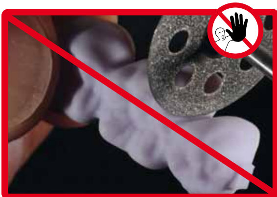
Ne pas utiliser de disques pour travailler les espaces interdentaires.
