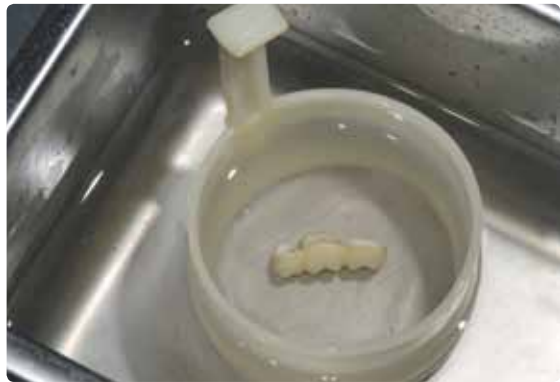
Retirer les résidus de matériau IPS Object Fix Putty ou Flow dans un bain à ultrasons et/ou au jet de vapeur.
