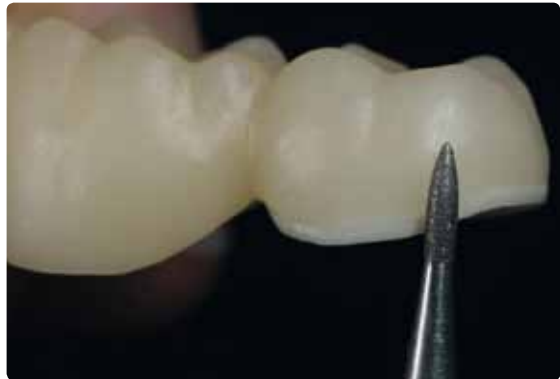
Gratter les éventuels excès de matériau IPS e.max CAD Crystall./Connect à l'aide d'une fine pointe diamantée.
