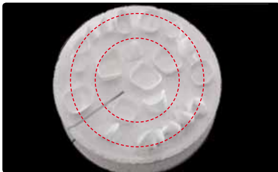
Positionnement des armatures en cercles serrés sur le plateau de frittage. Celui-ci garantit une répartition thermique régulière à l'intérieur de l'armature lors de la chauffe ou du refroidissement.
