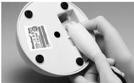
Inserte la clavija de conexión en la pieza de mano hasta que oiga y sienta que ha encajado en su posición.
