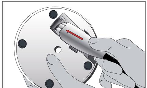
Conectar o cabo de força à rede elétrica e à fonte. Certifique-se de que o cabo de alimentação de energia esteja facilmente acessível em todos os momentos e que pode ser facilmente desconectado da fonte de alimentação. O indicador de força acende em verde e o anel iluminado na base de carregamento acende-se brevemente em azul.
