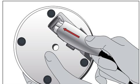
Conecte el cable eléctrico al suministro energético y a la unidad de alimentación. Asegúrese que el cable eléctrico esté accesible en todo momento y que pueda ser fácilmente desconectado de la fuente de alimentación. El indicador de encendido de la fuente de alimentación aparece en verde y el botón iluminado en azul corresponde a la base de carga.
