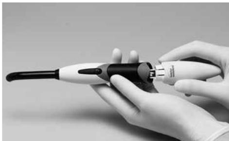
Suavemente, colocar a peça de mão no respectivo apoio da base de recarga, sem usar qualquer força. Se uma barreira de proteção para higiene for usada, remova-a, antes de carregar a bateria. Se possível, sempre utilize a lâmpada com a bateria completamente carregada. Isto prolongará a vida útil. Assim, também é recomendado colocar a peça de mão na base de recarga após cada paciente. Quando a bateria estiver totalmente descarregada, o tempo de recarga será de 2 horas.
