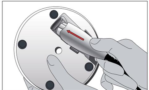
Collegare il cavo d'alimentazione alla presa di corrente e al trasformatore. Prestare attenzione a poter accedere facilmente al cavo di alimentazione in qualsiasi momento e che possa facilmente essere staccato dalla rete di alimentazione. La visualizzazione Power sull'alimentatore si illumina in colore verde e l'anello illuminato sulla base di ricarica lampeggia brevemente in blu.
