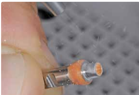
Sabler soigneusement la zone de collage avec Al_2O_3 (50-100 \mu m ) à faible pression jusqu'à obtenir une surface mate.
