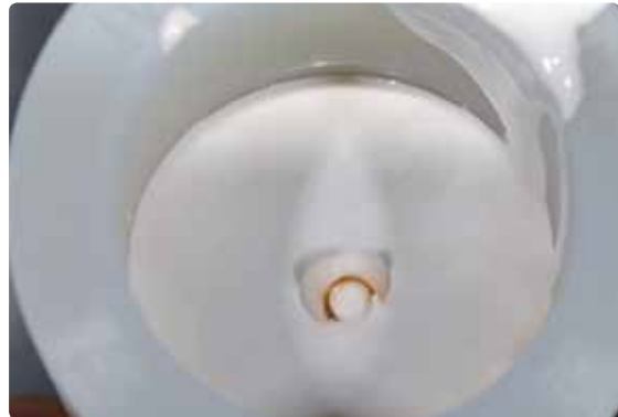
Verser le revêtement dans le cylindre, de manière à remplir le puits de vis de manière homogène.
