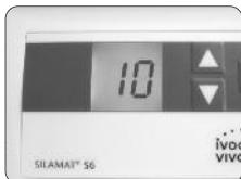
**6. Sélectionner le temps de malaxage :** il peut être fixé de 1 à 30 secondes. En général, un temps de malaxage de 10 secondes est suffisant (sauf si d'autres temps de malaxage sont recommandés dans le mode d'emploi du matériau par le fabricant). Par défaut, un temps de malaxage de 10 secondes est pré-enregistré sur le Silamat S6. Le dernier temps de malaxage utilisé reste mémorisé même si l'appareil a été mis hors tension.
