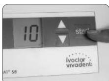
**7. Appuyer sur la touche "Start".** Dès la fin du temps de malaxage programmé, l'appareil s'arrête automatiquement et la capsule peut être retirée. L'appareil n'étant pas doté de touche "Stop", le malaxage peut être arrêté par l'ouverture du capot.
