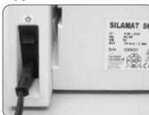
1. Forbind strømkabelen med kontakten på baksiden av apparatet og deretter med nettstikkontakten.
