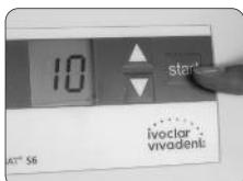
7. Tryk på starttasten. Efter at den indstillede blandingstid er udløbet, standser blanderen automatisk, og kapslen kan tages ud. Hvis man ønsker en førtidig afbrydelse af blandingsprocessen, skal beskyttelsesdækslet åbnes.
