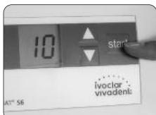
7. Premere il tasto "Start". Esaurito il tempo di miscelazione prescelto, il miscelatore si ferma automaticamente e la capsula può essere rimossa. Per interrompere il processo prima dello scadere del tempo di miscelazione impostato, sollevare la cuffia di protezione.
