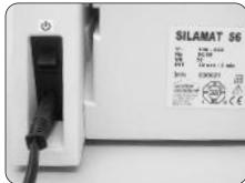
1. Um das Gerät auszuschalten, muss das Netzkabel aus der Gerätesteckdose oder dem Netzsteckdose entfernt werden.
