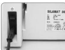
1. Brancher la prise femelle du câble d'alimentation à l'arrière de l'appareil, puis le relier au secteur.
