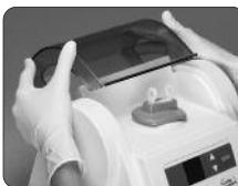
Schakel het apparaat vóór het reinigen uit en trek de stekker uit het stopcontact. Neem de behuizing, het toetsenbord en de beschermkap af met een zachte doek en een gebruikelijk desinfectiemiddel zonder aldehyde.
