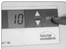
7. Start tuşuna basın. Ayarlanan karıştırma süresi bittikten sonra karıştırıcı otomatik olarak durur ve kapsül çıkarılabilir. Karıştırma işlemini daha önce kesmek isterseñiz koruyucu kapağı açmalısınız.
