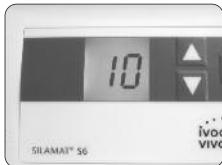
6. Valg af tid for blandingsprogrammet: Blandingstiden kan ved Silamat S6 vælges til at vare mellem 1 og 30 sekunder. Generelt kan der anvendes en blandingstid på 10 sekunder (undtagen, hvis producenten af materialet i sin brugsanvisning anbefaler andre blandingstider). Som standard er Silamat S6 indstillet til 10 sekunder. Den sidst anvendte blandingstid forbliver lagret, også selvom apparatet i mellemtiden har været slukket.
