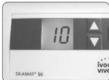
6. Selezionare il tempo di miscelazione, che nel Silamat S6 è impostabile da 1 a 30 secondi. Di norma si utilizza un tempo di miscelazione di 10 secondi (salvo diversa specifica nelle istruzioni d'uso del materiale utilizzato). Silamat S6 è stato preimpostato con un tempo di miscelazione di 10 secondi. L'ultimo tempo di miscelazione utilizzato rimane in memoria anche quando l'apparecchio nel frattempo è stato spento.
