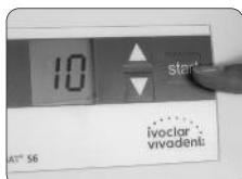
7. Pulse la tecla "Start". Una vez completado el tiempo de vibrado, Silamat S6 se para automáticamente, pudiendo retirar la cápsula. Si desea interrumpir el proceso de vibrado antes de finalizar, abra la tapa de seguridad.
