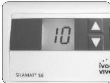
6. Auswahl der Mischprogrammzeit: Die Mischzeit kann beim Silamat S6 zwischen 1 – 30 Sekunden gewählt werden. Generell kann eine Mischzeit von 10 Sekunden verwendet werden (ausser es werden vom Materialhersteller in der Gebrauchsinfo andere Mischzeiten empfohlen.) Standardmäßig wurde der Silamat S6 auf 10 Sekunden eingestellt. Die zuletzt verwendete Mischzeit bleibt gespeichert, auch wenn das Gerät in der Zwischenzeit ausgeschaltet wurde.
