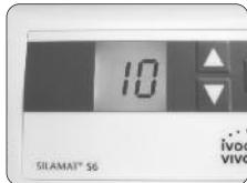
6. Seleccione el tiempo de vibrado: El tiempo de vibrado se puede ajustar entre 1 y 30 segundos. Por lo general, se puede utilizar un tiempo de vibrado de 10 segundos (a no ser que en las instrucciones de uso del fabricante del material se indiquen otros tiempo de vibrado). Por defecto, Silamat S6 está programado a 10 segundos. El último tiempo de vibrado utilizado queda almacenado incluso si se apaga el aparato.
