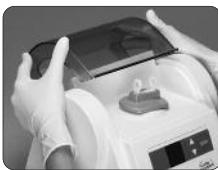
Antes de proceder à limpeza, coloque o interruptor na posição desligada e tire a ficha da tomada. Limpe o corpo, o teclado e a cobertura de protecção com um pano macio e um produto desinfectante comum isento
