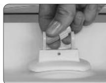
4. Einsetzen der Mischkapsel in die Mischgabel.
