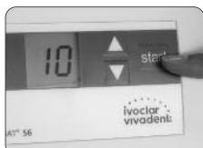
7. Druk op de starttoets. Na afloop van de ingestelde mengtijd stopt de menger automatisch en kan de capsule uit het apparaat worden genomen. Wanneer het mengen in een eerder stadium moet worden onderbroken, kan dit door de beschermkap te openen.
