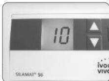
6. Karıştırma süresinin seçilmesi: Silamat S6'daki karıştırma süresi 1 - 30 saniye aralığında seçilebilir. Genel olarak 10 saniyelik bir karıştırma süresi kullanılabilir (materyal üreticisi kullanım bilgilerinde başka karıştırma süreleri önermediği takdirde). Silamat S6 standart olarak 10 saniyeye ayarlanmıştır. Cihaz kapatılmış olsa bile, son kullanılan karıştırma süresi kaydedilir.
