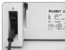
1. Das Netzkabel auf der Geräterückseite mit der Gerätesteckdose und anschliessend mit der Netzsteckdose verbinden.
