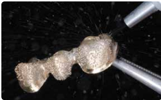
Sabler soigneusement l'armature à l' Al_2O_3 (80–100 \mu m ) à 2–3 bar de pression et tapoter à l'aide d'un instrument.
