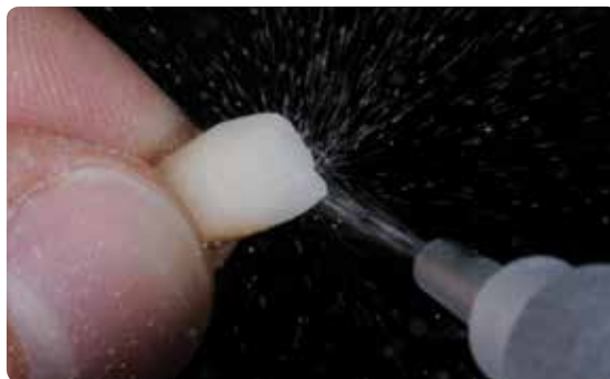
Réalisation du cut-back. Sabler la surface à l' Al_2O_3 (80-100 \mu m ) à 2 bar de pression.
