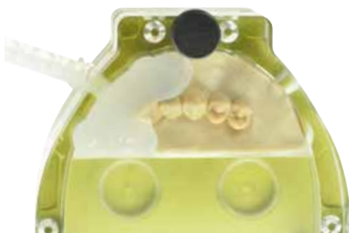
Remplir le moufle avec du silicone transparent Transil F.
