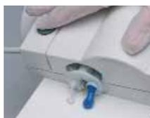
Expulser une petite quantité de matériau avant de placer l'embout de mélange pour vérifier que les 2 composants s'écoulent de manière régulière.
