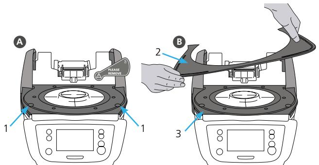
B Legen Sie nun die Brenngut-Ablageplatte (2) auf die Rahmenplatte (3). Achten Sie dabei, dass die Brenngut-Ablageplatte korrekt auf der Rahmenplatte aufliegt.
