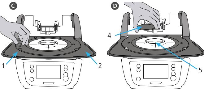
C Fixe a bandeja de resfriamento com os dois parafusos (1).
