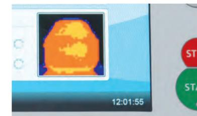
Une image thermique de l'objet à l'intérieur du four est affichée à l'écran pendant le chargement du four.
