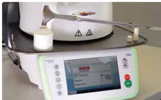
Placer le lingotin IPS e.max Press Multi **froid** dans le cylindre **chaud** avec le côté arrondi non marqué dirigé vers l'avant. Le côté marqué est tourné vers le haut pour le contrôle de la teinte du lingotin.
