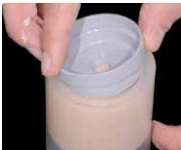
Remplir le cylindre jusqu'à la limite et positionner le gabarit IPS Ring Gauge par un mouvement de bascule. Les excès de revêtement s'échappent par l'ouverture. Laisser prendre le cylindre sans le toucher.
