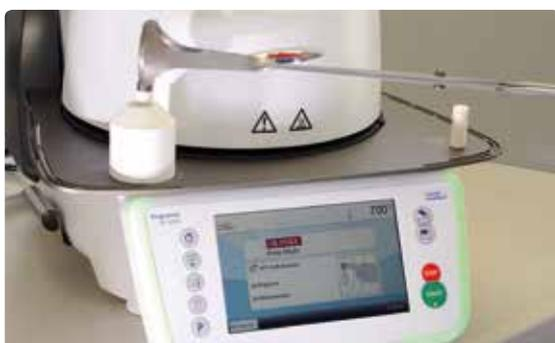
Positionner le piston IPS Multi One-Way Plunger **froid** dans le cylindre chaud, côté arrondi vers l'avant.
