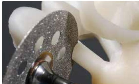
Retirer les tiges de pressée des restaurations monochromes à l'aide d'un disque à tronçonner
