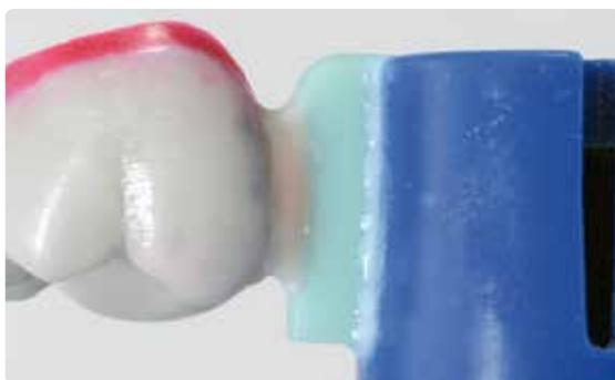
Fermer les espaces entre la préforme en cire IPS Multi Wax Pattern et le cylindre IPS Multi Investment Ring Base avec une petite quantité de cire à modeler.
