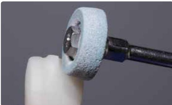
Meulage des tiges de pressée à une vitesse de rotation réduite et finition des surfaces.
