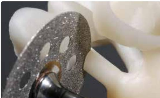
Retirer les canaux de pressée avec un disque diamanté fin sous irrigation permanente.
