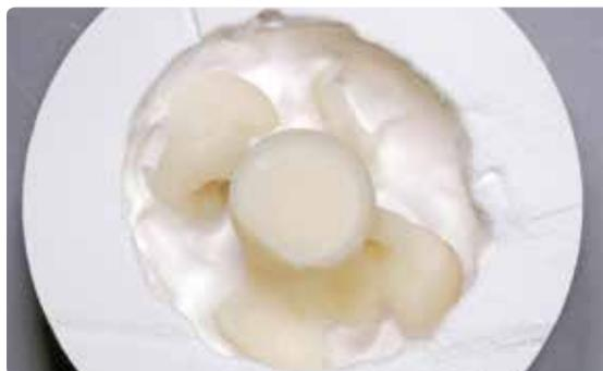
Le délitage grossier se fait au lustrant sous une pression de 4 bar jusqu'à ce que les éléments soient visibles.
