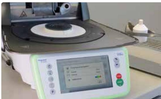
Au terme du programme de pressée, placer le cylindre chaud à l'aide de la pince sur la grille de refroidissement et laisser refroidir à température ambiante.
