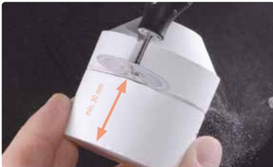
À l'aide d'un disque à tronçonner, marquer le cylindre à une distance d'au moins 30 mm de sa base...
