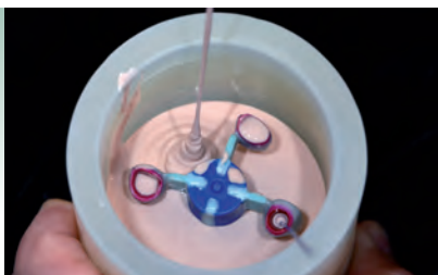
Mise en revêtement
