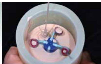
Mise en revêtement
