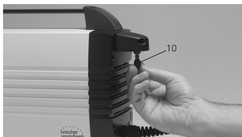
Conectar el otro extremo del tubo de vacío con el horno. Por favor, revise si la manguera está adecuadamente conectada.
