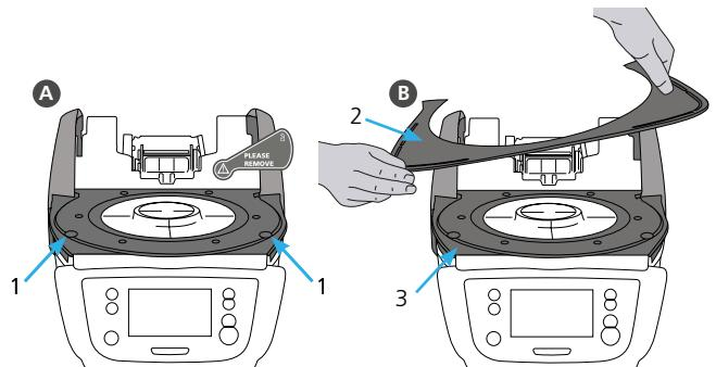
B Posicione a bandeja de resfriamento (2) na plataforma da estrutura (3). Certifique-se que a bandeja de resfriamento está posicionada corretamente na plataforma da estrutura.
