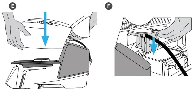
F Encaixe a cabeça do forno conforme a figura até sentir um clique na posição. Certifique-se que tanto a plataforma de queima como o isolamento não tenham sido danificados durante a montagem da cabeça do forno.
