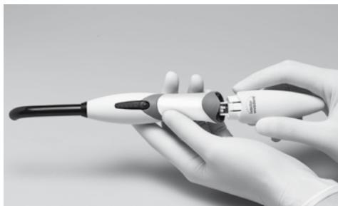
Colocar la pieza de mano con suavidad en el apoyo correspondiente de la base de carga. Si se utilizó la funda higiénica, por favor retírela antes de cargar la batería. Si fuera posible, utilice la lámpara siempre con una batería completamente cargada, ya que ello prolongará la vida útil. Por ello se recomienda colocar la pieza de mano en la base de carga después de cada paciente. El tiempo de carga para baterías vacías es de 2 horas.
