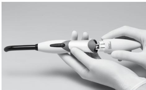
Handstück ohne Kraftaufwand in die Öffnung der Ladestation einsetzen. Falls ein Hygieneschutz verwendet wird, muss dieser vor dem Laden des Akkus entfernt werden.
