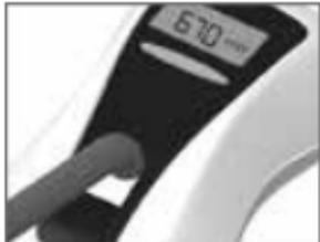
Analogamente alle fasi 3.)–6.), il risultato di misurazione del flusso energetico viene visualizzato in milliwatt [mW].
