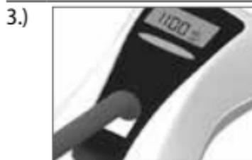
Anbring lyslederen direkte på centreringslæreren og på linje med sensorens overflade.
