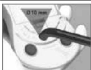
Καθορίστε τη διάμετρο του κυκλικού φωτοανιχνευτή με χρήση του ενσωματωμένου προτύπου στο πίσω μέρος της συσκευής.
