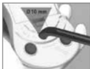
Definieer met behulp van de geïntegreerde sjabloon aan de achterkant van het apparaat de diameter van de ronde lichtgeleider.
