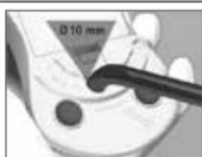
Definir el diámetro del conducto de luz usando la plantilla integrada en la parte posterior del dispositivo
