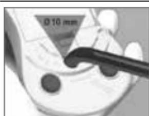
Durchmesser des kreisrunden Lichtleiters mittels integrierter Schablone auf der Gehäuserückseite bestimmen.
