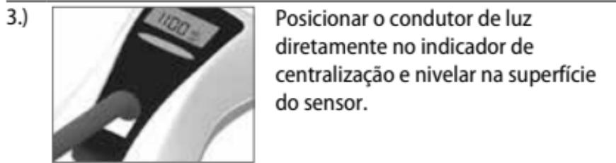
Posicionar o condutor de luz diretamente no indicador de centralização e nivelar na superfície do sensor.
