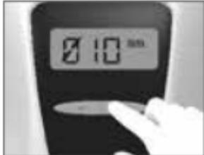
Impostare il diametro rilevato << Ø 6 – 12 mm >> con i tasti (-) oppure (+).
