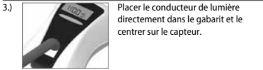
Placer le conducteur de lumière directement dans le gabarit et le centrer sur le capteur.
