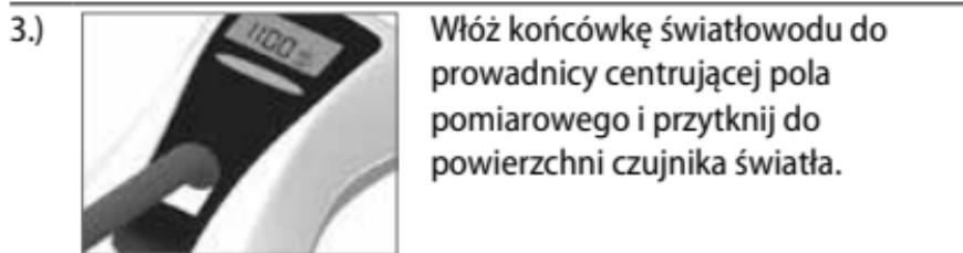
Włóż końcówkę światłowodu do prowadnicy centrującej pola pomiarowego i przytnij do powierzchni czujnika światła.
