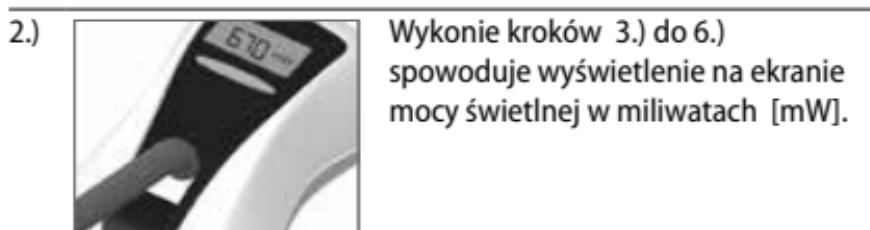
Wykonanie kroków 3.) do 6.) spowoduje wyświetlenie na ekranie mocy świetlnej w miliwatach [mW].
