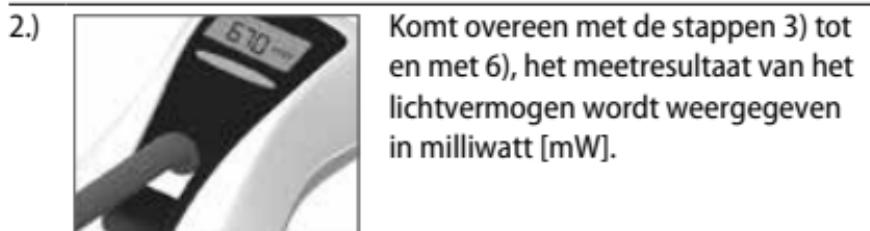
Komt overeen met de stappen 3) tot en met 6), het meetresultaat van het lichtvermogen wordt weergegeven in milliwatt [mW].
