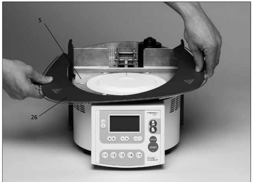
Serrer ensuite avec les deux vis de fixation (27) la tablette de service (26) ainsi que le support silicone (28).
