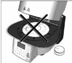
Ne jamais utiliser le four sans table de frittage. N'utiliser que le plateau de sinterisation Programat. Ne pas utiliser de support de cuisson ou de support en nid d'abeille de fours conventionnels. Avant chaque cycle de frittage, contrôlez si la table de frittage ne présente pas de dommages, fissures ou salissures. Si la table est endommagée, ne pas l'utiliser. Une table au maximum peut être positionnée dans la chambre de cuisson – ne pas les empiler !
