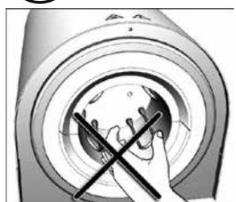
Ne pas toucher le thermocouple et l'élément de chauffe dans la chambre de frittage. Eviter le contact avec la peau (salissure grasse) car les éléments seraient plus vite endommagés.
