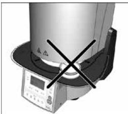
Pour ne pas gêner la fermeture de la tête du four, ne pas placer le plateau de sinterisation en dehors de la table de cuisson.
