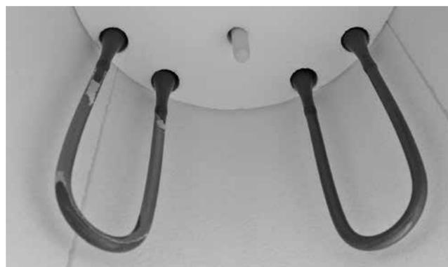
Sur l'élément de chauffe gauche, la couche de protection est écaillée sur une grande partie. L'élément de chauffe droit est en bon état avec une couche protectrice d'oxydes intacte. La cuisson de nettoyage doit être répétée jusqu'à ce que la surface soit exempte de contaminations et présente une apparence vitreuse.
