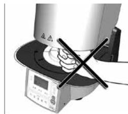
Pendant le fonctionnement, ne jamais introduire la main sous la tête du four. Il y a risques de pincement et de brûlure.
