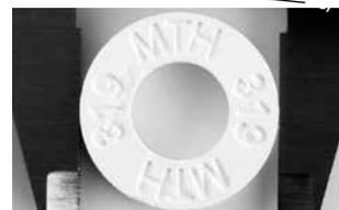
6. Rechercher le diamètre relevé dans le tableau de conversion et lire la valeur de correction de température correspondante. Dans le cas où l'écart est supérieur à 10 °C, l'appareil devra être ajusté.
