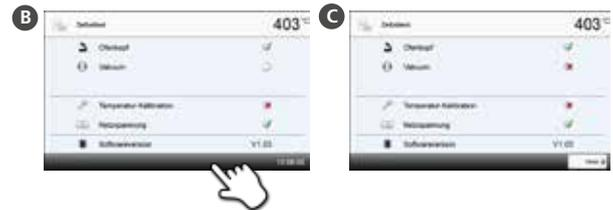
Am Ende des Programms öffnet der Ofenkopf automatisch. Sobald die OSD-Anzeige grün leuchtet, steht der Ofen für den nächsten Programmstart zur Verfügung.
