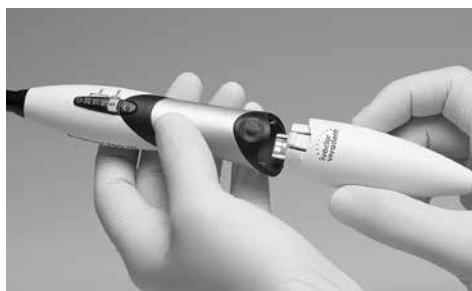
La batterie est un consommable et doit, de ce fait, être remplacée environ tous les 2,5 ans, cycle de vie d'une batterie. Voir l'âge de la batterie sur l'étiquette.
