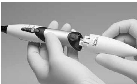
Der Akku ist ein Verschleissteil, das typischerweise nach ca. 2½ Jahren erneuert werden muss. Das Alter des Akkus kann dem Akkuaufkleber entnommen werden.
