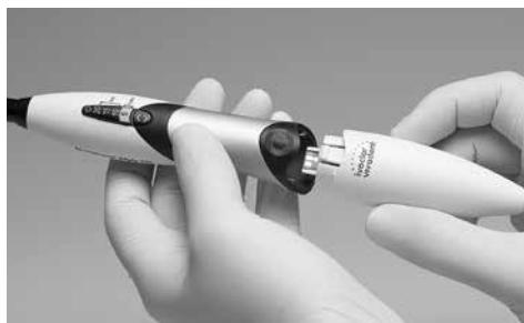
La batteria è un materiale di consumo, che generalmente deve essere sostituito dopo ca. 2½ anni. L'età della batteria può essere rilevata dall'etichetta sulla batteria stessa.
