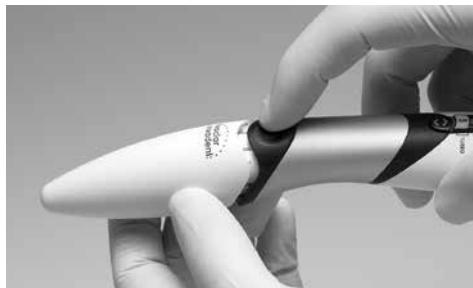
Para ello, retire la batería de la pieza de mano apretando el botón de retirada.
