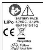
Por favor, tenga en cuenta que la batería de polímero de litio puede reaccionar con explosión, fuego y producir humo en caso de una manipulación inapropiada y daños mecánicos. Baterías de polímero de litio dañadas, no deben volver a utilizarse.
