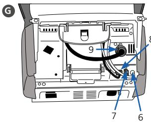
H Inserire la spina della resistenza nell'apposito allacciamento. Fissare la spina della resistenza con un movimento di 45°.
