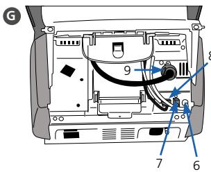
H Insérer la fiche de chauffe dans le connecteur spécifié. Sécuriser la fiche de chauffe grâce à une rotation de 45°.
