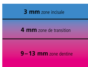
Répartition dentine/incisal dans le disque IPS e.max ZirCAD Prime non fritté
