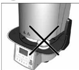
Pour ne pas gêner la fermeture de la tête du four, ne pas placer le plateau de sintérisation en dehors de la table de cuisson.
