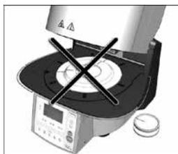
Ne jamais utiliser le four sans le plateau de sintérisation. N'utiliser que le plateau de sintérisation Programat d'origine. Ne pas utiliser de supports de cuisson ou en nid d'abeille provenant de fours à céramiques classiques. En outre, toujours vérifier que le plateau de sintérisation ne comporte aucun signe de dommages, de fêlures ou de
