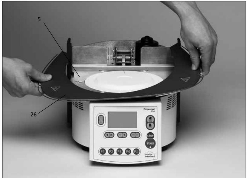
Fixer ensuite la tablette de service (26) avec les deux vis de fixation et placer les protections en silicone (28).
