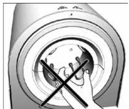
Ne pas toucher le thermocouple et les éléments de chauffe dans la chambre de sinterisation. Éviter tout contact avec la peau (dépôt d'un film gras) qui provoquerait une usure prématurée des pièces.
