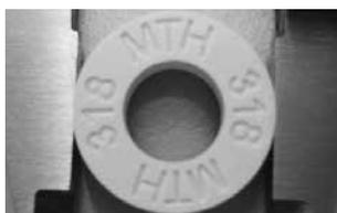
6. Rechercher le diamètre relevé dans le tableau de conversion et lire la température correspondante. Si l'écart est supérieur à 10 °C, l'appareil devra être ajusté.
