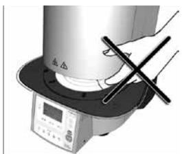
La tête du four est équipée d'un mécanisme électrique permettant de l'actionner par électronique. Ne jamais ouvrir la tête du four manuellement, au risque d'endommager la transmission.
