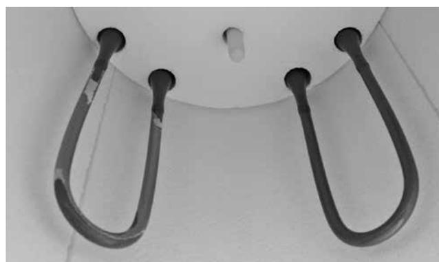
De grosses parties de la couche protectrice sont endommagées sur la partie gauche des éléments de chauffe. Les éléments de chauffe sur la partie droite sont dans un état bon et stable : la couche d'oxydes / protectrice est intacte. Le programme de nettoyage doit être répété jusqu'à obtention d'une surface saine et transparente.
