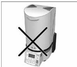
Pour des raisons de sécurité, le four ne doit pas être utilisé sans tablette de service.
