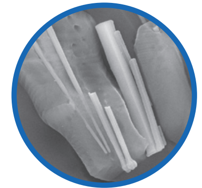
Oxyapatite en forme d'aiguilles Contrôle ciblé de la translucidité et de l'opacité Grossissement x10 000
