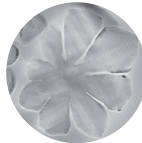
Leucite cristalline Expansion contrôlée et résistance Grossissement x 8 200
