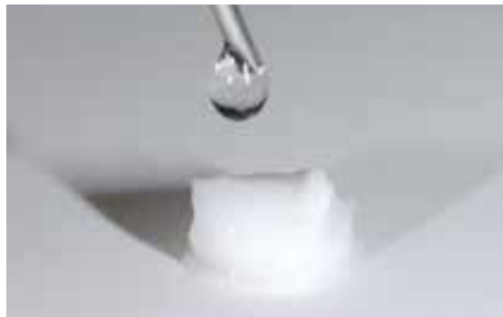
Mélange de la glasure en pâte IPS Ivocolor Glaze avec IPS Ivocolor Mixing Liquid allround ou longlife
