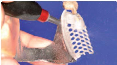
Sablage à l' $\text{Al}_2\text{O}_3$  Type 100 sous 2-4 bar de pression
