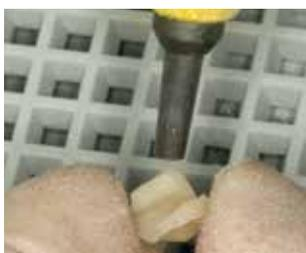
Sabler la surface de liaison à l'oxyde d'aluminium 50–100 µm à 1–1,5 bar de pression.
