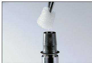
2. Protéger le puits de vis à l'aide d'une boulette de mousse ou de cire. Éviter toute contamination de la surface de collage au cours du traitement.
