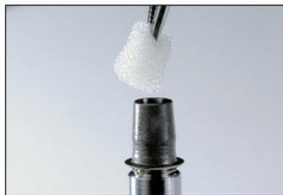
2. Protéger le puits de vis à l'aide d'une boulette de mousse ou de cire. Éviter toute contamination de la surface de collage au cours du traitement.
