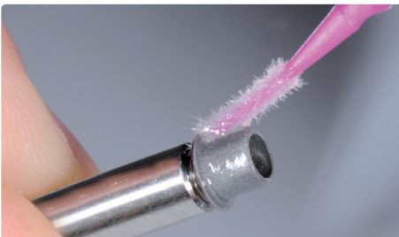
Monobond Plus auf die gereinigte Klebefläche auftragen und 60 Sekunden einwirken lassen. Nach der Einwirkzeit den verbleibenden Überschuss mit wasser-/ölfreier Luft trocken blasen.
