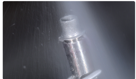
Optional: Reinigung mittels Instrument und Dampfstrahler. Unbedingt darauf achten, dass das gesamte Wachs gründlich entfernt ist
