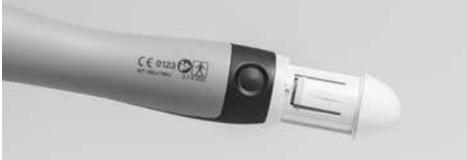
Handstück ohne Kraftaufwand in die Öffnung der Ladestation einsetzen. Falls ein Hygieneschutz verwendet wird, muss dieser vor dem Laden des Akkus entfernt werden. Nach Möglichkeit ist das Gerät stets mit vollgeladenem Akku zu benutzen – dies dient der Verlängerung der Lebensdauer. Es wird daher empfohlen nach jedem Patienten das Handstück in die Ladestation zu stellen. Bei leerem Akku dauert die Aufladezeit 2 h.
