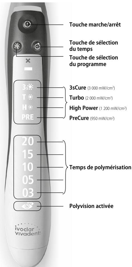
Respecter le mode d'emploi des matériaux utilisés lors de la sélection du programme et de l'intensité. Sauf indication contraire dans le mode d'emploi du matériau utilisé, photopolymériser par couche de 2 mm maximum. Généralement, ces recommandations s'appliquent dans les situations où l'embout lumineux est orienté directement sur le matériau à polymériser. Si l'on augmente la distance entre la source de lumière et le matériau, augmenter le temps de polymérisation en conséquence. Par exemple,
