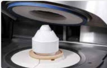
Placer le cylindre **chaud** ainsi équipé au centre du four **chaud** à l'aide de la pince à cylindres.
