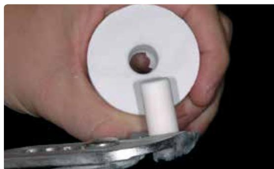
Le piston Alox se retire très proprement s'il est délicatement tourné avec une pince. Dans tous les cas, vérifier sa propreté et sabler à l' $Al_2O_3$ , le cas échéant.
