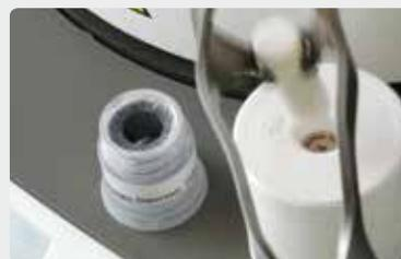
Placer ensuite le piston AloX IPS e.max poudré dans le cylindre **chaud**.
