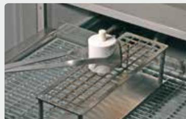
Au terme du programme de pressée, placer le cylindre **chaud** à l'aide de la pince sur la grille de refroidissement et laisser refroidir à température ambiante.
