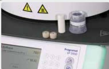
Préparer un piston IPS AloX **froid** et le lingotin IPS InLine PoM **froid** de la teinte souhaitée.
