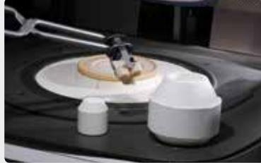
Placer le lingotin IPS InLine PoM **froid** dans le cylindre **chaud** avec la teinte des lingotins vers le haut.
