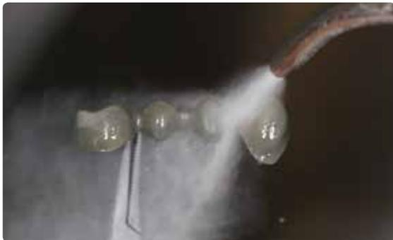
Après sablage, nettoyer l'armature métallique au jet de vapeur et laisser sécher. Procéder à la cuisson d'oxydation selon les recommandations du fabricant.
