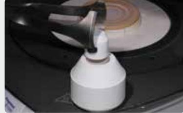
Placer ensuite le piston IPS One-Way 300 g **froid** dans le cylindre **chaud**.
