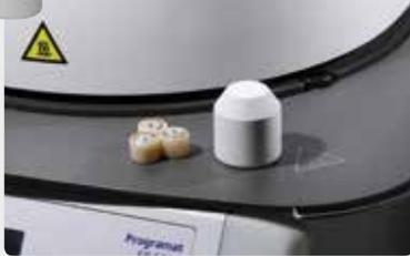
Préparer un piston IPS One-Way **froid** et les lingotins IPS InLine PoM **froids** de la teinte souhaitée.
