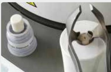
Placer le lingotin IPS InLine PoM **froid** dans le cylindre **chaud** avec la teinte du lingotin vers le haut.
