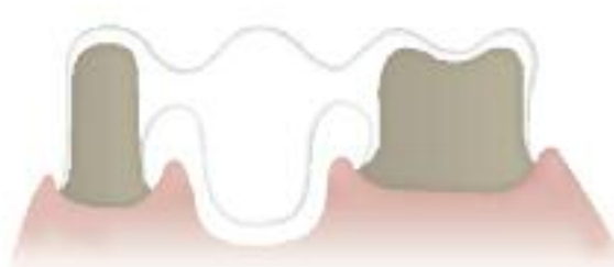
Dans le cas d'une crête alvéolaire atrophiée, l'armature doit être adaptée au tracé de la fausse gencive
