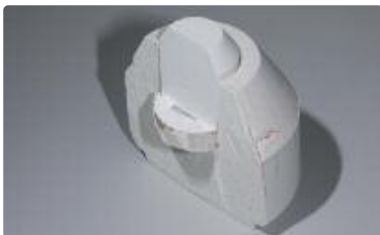
Séparer le cylindre de 300 g à l'aide d'un disque à tronçonner au niveau du repère Pour les cylindres de 100 g et 200 g, séparer au niveau du repère à la hauteur du piston Alox
