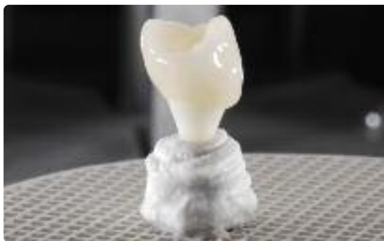
Réaliser la cuisson de maquillage et de caractérisation sur un support en nid d'abeille avec les paramètres de cuisson indiqués
