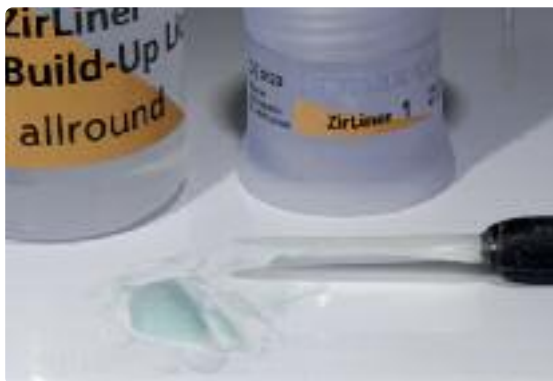
Mélanger le ZirLiner choisi avec le ZirLiner Liquid correspondant pour obtenir une consistance crémeuse
