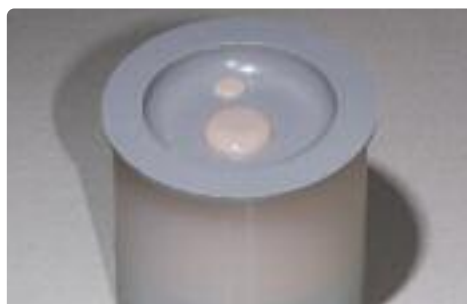
Laisser prendre le revêtement en évitant toute vibration
