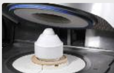
Placer le cylindre chaud ainsi équipé au centre du four de pressée chaud à l'aide de la pince
