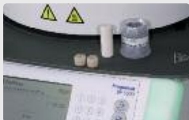
Préparer le piston froid IPS AloX et les lingotins froids IPS e.max ZirPress dans la teinte désirée
