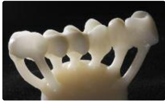
Eliminer la couche de réaction avec le liquide Invex puis de l' Al_2O_3 sous 1–2 bar de pression
