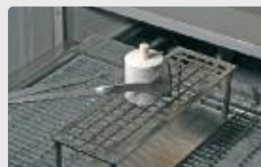
A la fin du programme de pressée, placer cylindre chaud à l'aide de la pince sur la grille de refroidissement et laisser refroidir à température ambiante
