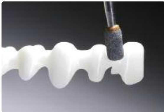
Effectuer une dernière finition avec des instruments à meuler spécialement conçus pour ZrO_2
