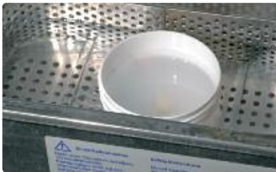
Eliminer la couche de réaction avec le liquide Invex puis de l' Al_2O_3 sous 1–2 bar de pression
