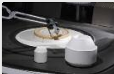
Insérer dans le cylindre chaud les lingotins froids IPS e.max ZirPress avec le côté marqué dirigé vers le haut
