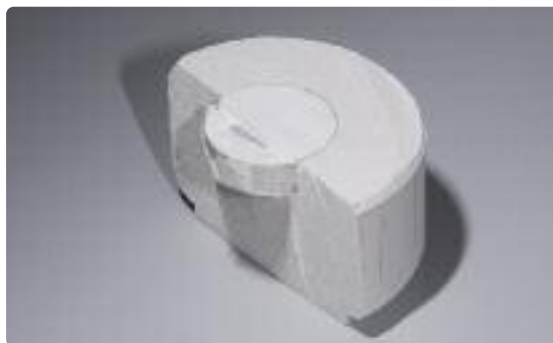
Séparer le cylindre de 300 g à l'aide d'un disque à tronçonner au niveau du repère Pour les cylindres de 100 g et 200 g, séparer au niveau du repère à la hauteur du piston Alox
