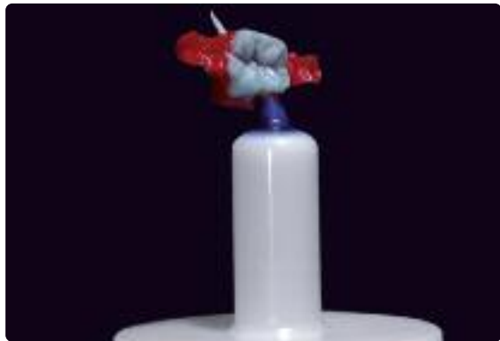
Modelage fixé avec une tige de cire (3 mm de diamètre). La tige de maintien sur l'armature ZirCAD bloque l'armature dans la masse de revêtement
